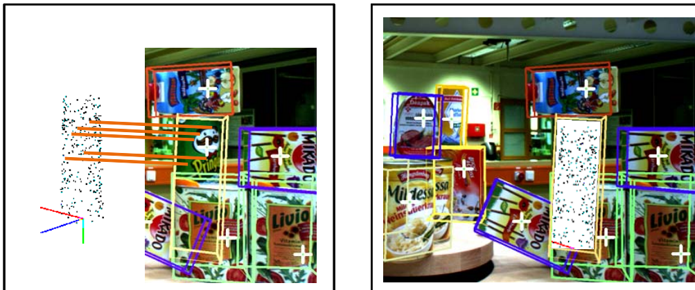
Bild 7: Erkennung und Lokalisierung unterschiedlicher Objekte
